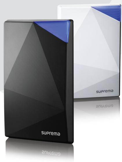
엑스패스 에스2 슈프리마 엑스패스 에스2는 IP네트워크 기반의 출입통제 단말기로서 중소규모 및 대규모 시스템에서 고효율, 고성능의 출입보안 기능을 제공 합니다. 멀티 카드리딩을 지원하여 13.56MHz ISO14443A/B, ISO15693, Mifare, DesFire(CSN), Felica, 전자공무원증의 카드를 하나의 카드리더에서 동시에 인식이 가능 합니다. 엑스패스 에스2는 차세대 분산형 시스템 구조에서 카드리더기와 컨트롤러 기능을 동시에 수행 하며 TCP/IP, RS485 및 Wiegand 인터페이스를 통해 기존 시스템과 완벽한 호환을 가능하게 합니다. 또한 슈프리마의 BioStar 시스템과 연동을 통해 출입통제 또는 근태관리 시스템을 구성 할 수 있습니다.
